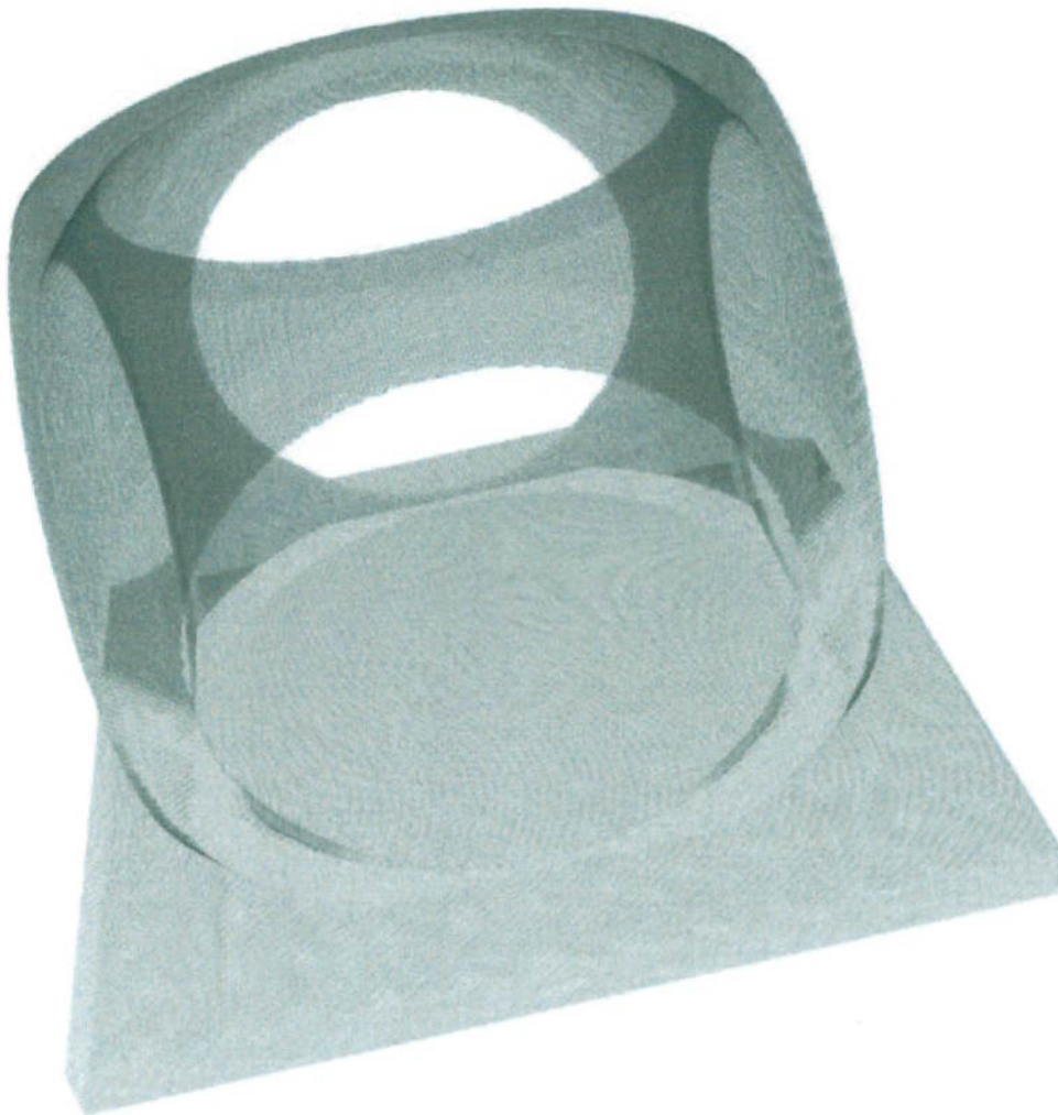
Figura 6.10. Peça formada apenas por paralelepípedos e esferas. Foram processados 277795 cubos e gerados 553632 triângulos.
