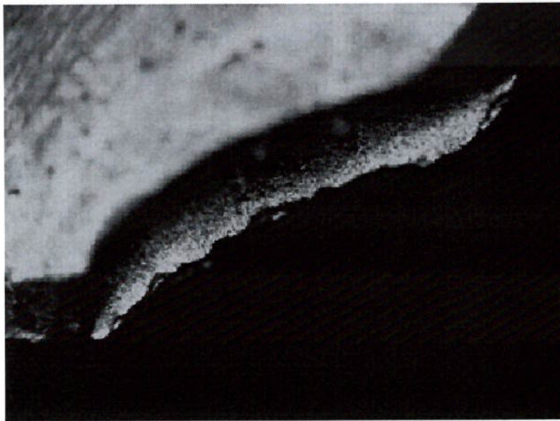
Figura 5.3 – inserto com aresta de corte fraturada; imagens obtidas do equipamento Zoller com aumento de 40x
