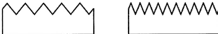
Figura 2.20 b.) – comparação do R_a para diferentes perfis (adaptado de HOMMELWERKE GMBH 41])
