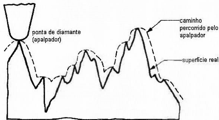
Figura 2.23 – condição de medição (rugosidade)
