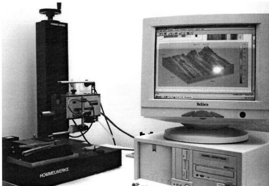
Figura 2.22 – perfilômetro Hommelwerke T8000 (adaptado de HOMMELWERKE GMBH [45])
