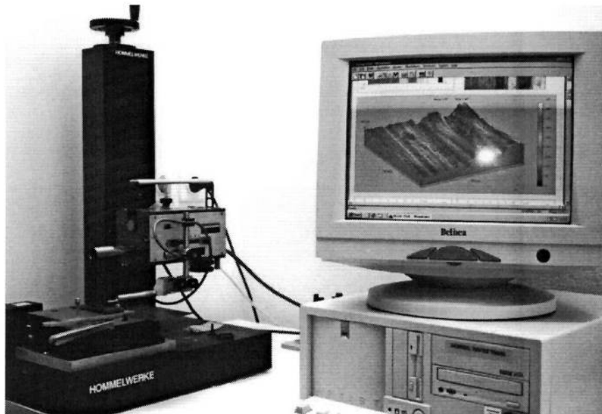
Figura 2.22 – perfilômetro Hommelwerke T8000 (adaptado de HOMMELWERKE GMBH [45])
