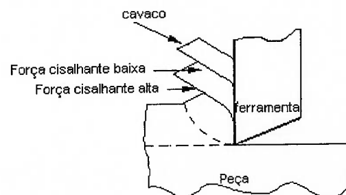
Figura 2.1 Relação entre o cavaco e a força de usinagem [13ASTAKAHOV 1997]
