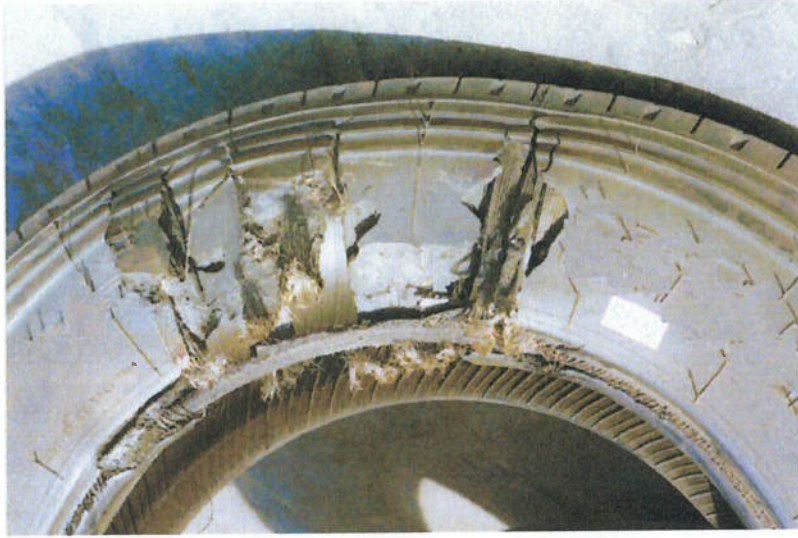
Fig. 5.47: Ruína estrutural de um pneu [123] .
