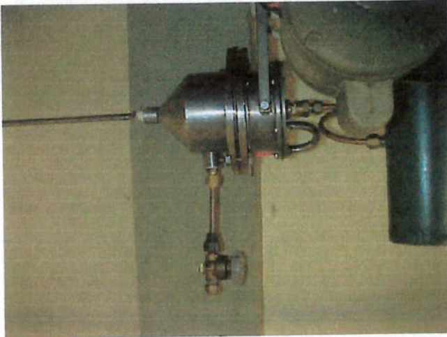
Figura 3.12 Câmara de coleta de material particulado contendo o filtro
