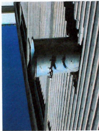
Figura 3.3 – Termopares instalados no duto de entrada e captação de ar
