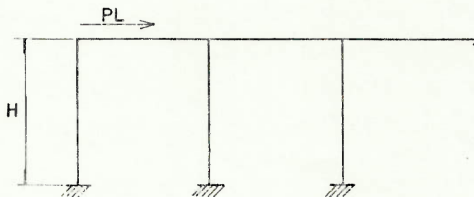
Fig. 6 - Momento Máximo na Coluna Devido à Força Longitudinal
