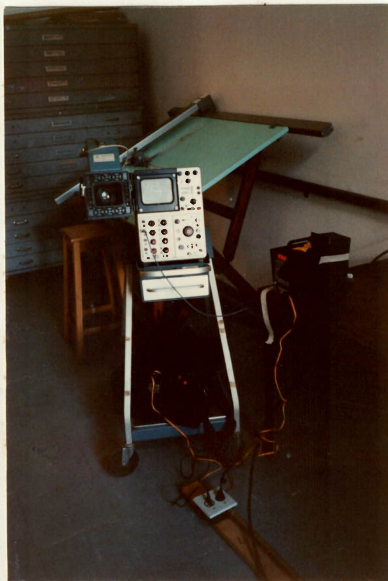
Fig. 6.22 - Aspecto geral do experimento. Sobre a mesa a lâmpada estroboscópica acoplada à caixa suporte. No carrinho, na parte inferior, a unidade fonte da lâmpada e, na superior, o osciloscópio (à direita) e a câmera fotográfica (à esquerda). Em operação, a câmera dobra-se sobre a tela do osciloscópio
