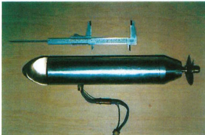
Fig. AA.12 – Conjunto Propulsor com o encapsulamento do motor e da lâmpada.
