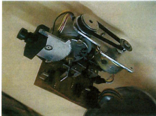
Fig. AA.9 – Mecanismo de acionamento da câmara.
