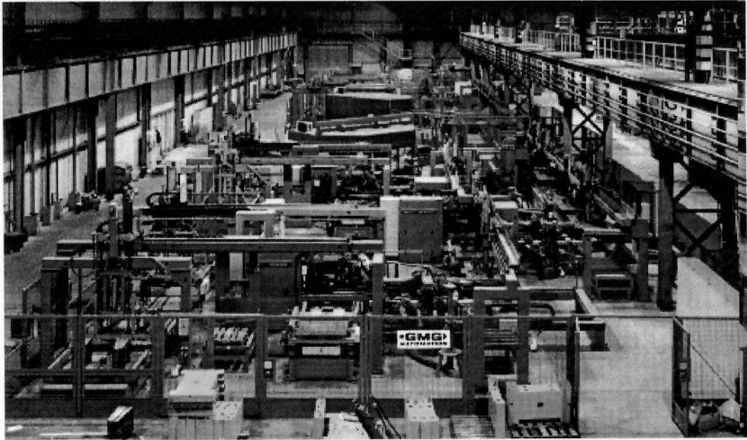
Figura 5: Linha de produção de Blank Soldado com sistema de manuseio contínuo para a manufatura de partes laterais [MtlFrmHdbk98].
