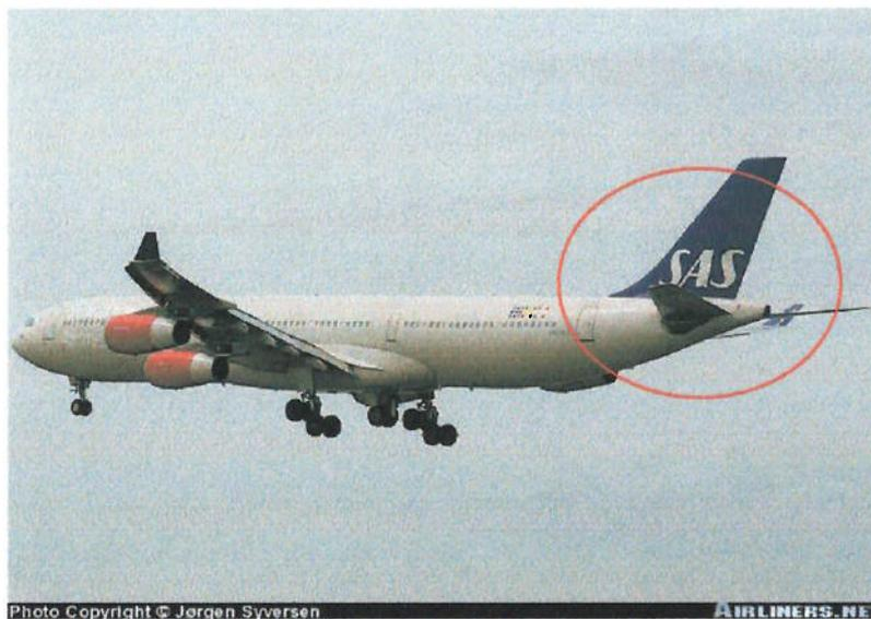
Figura 4.4: Localização da unidade auxiliar de potência na aeronave
