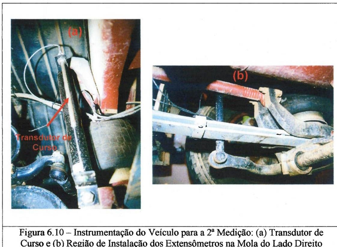
Figura 6.10 – Instrumentação do Veículo para a 2ª Medição: (a) Transdutor de Curso e (b) Região de Instalação dos Extensômetros na Mola do Lado Direito
