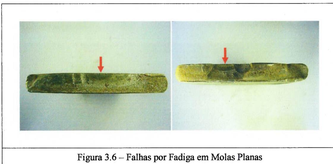
Figura 3.6 – Falhas por Fadiga em Molas Planas
