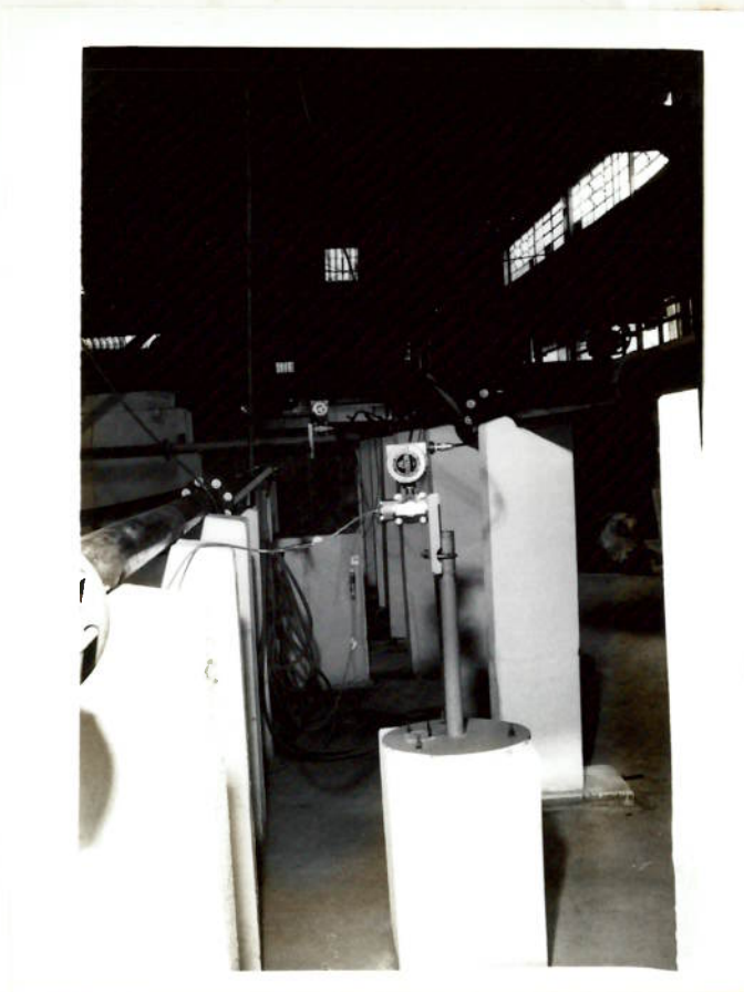
Foto (III.3) Transdutor de pressão nas seções 1 e 2.
