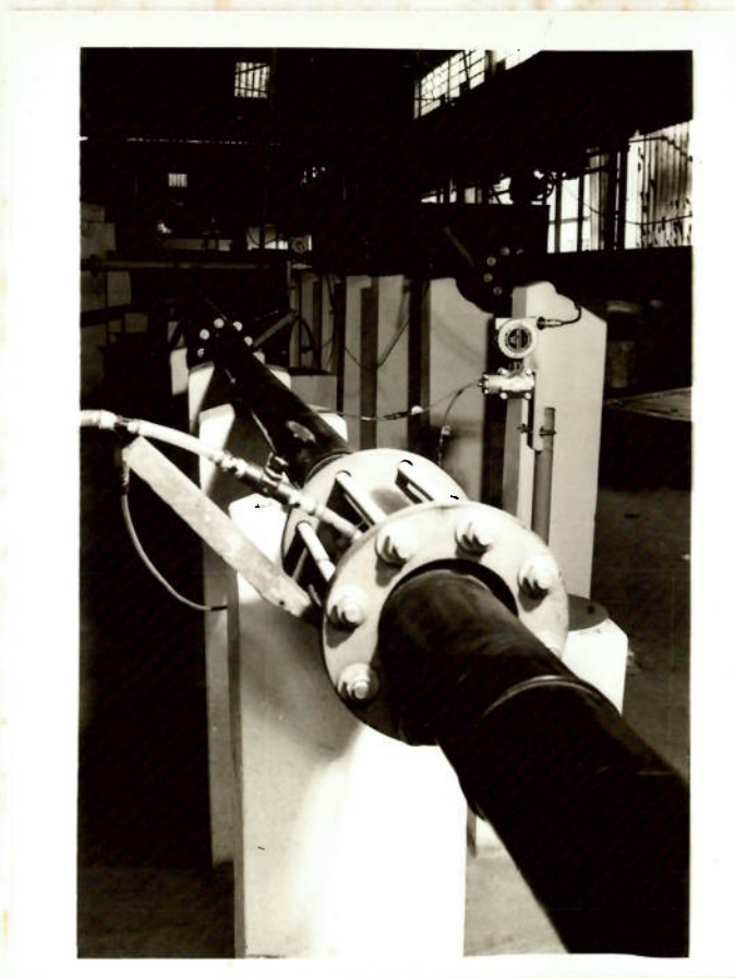
Foto (III.1) Vista lateral da seção de teste 1. Observe-se em primeiro plano a tomada de pressão e à direita o transdutor de pressão.
