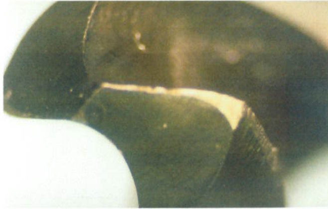
Figura 5.21 – Desgaste da broca depois de 160 furos executados no aço ABNT 5140
