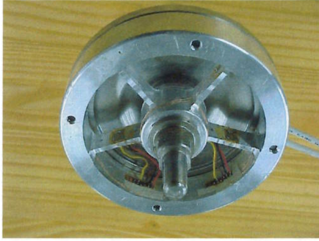
Figura 4.16 – Conectores dos extensômetros
