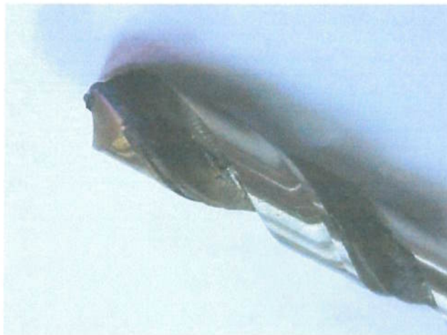
Figura 5.10 – Aparência da broca depois da furagem com avanço de 0.25 mm/volta
