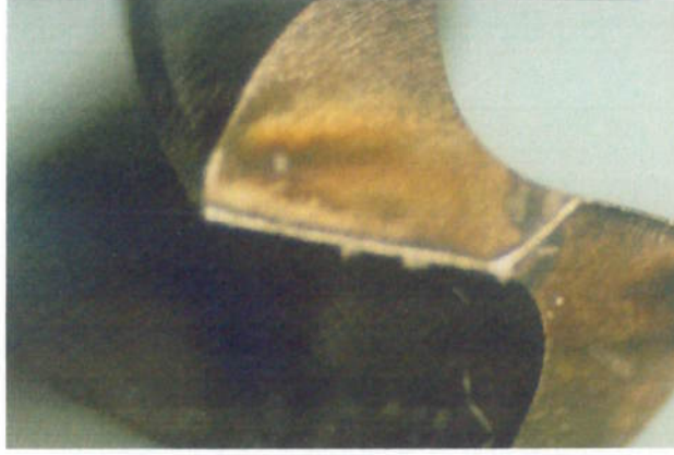
Figura 5.22 – Desgaste da broca depois de 160 furos executados no aço ABNT 1040
