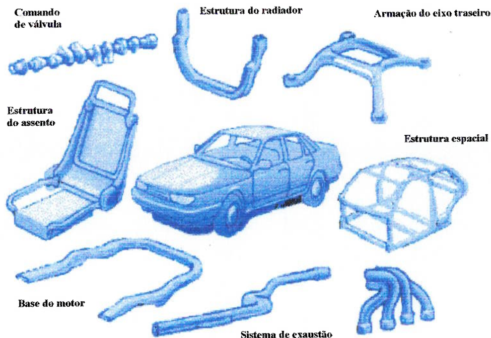
Fig. 3.2: Exemplo de peças hidroconformadas utilizadas na indústria automobilística (Fonte: http://www.cc.luth.sc/~joalun/hydroforming.html )
