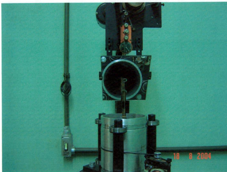
Figura 19: Detalhe da montagem do espelho em ângulo de 45^\circ
