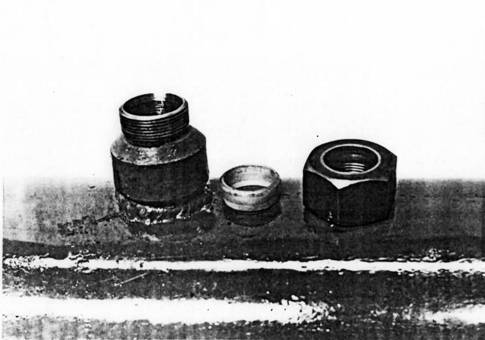
Figura 38 - Seção de testes com peças para fixar os multifuros.
