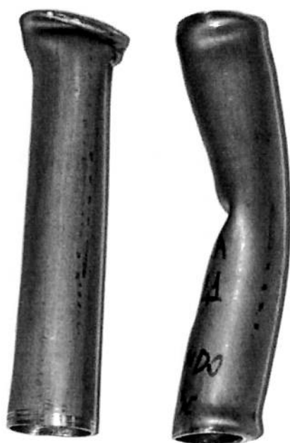
Figura 4.6 – Colapso dinâmico de tubos com 130 mm de comprimento. Velocidade de impacto de 5,05 m/s (à esquerda) e 4,65 m/s (à direita)
