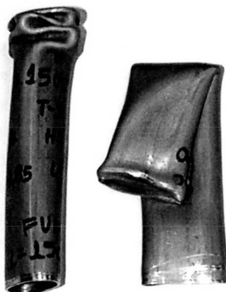
Figura 4.7 – Colapso dinâmico de tubos com 150 mm de comprimento. Velocidade de impacto de 8,69 m/s (à esquerda) e 8,58 m/s (à direita)
