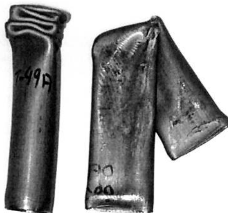
Figura 4.8 – Colapso dinâmico de tubos com 170 mm de comprimento. Velocidade de impacto de 10,85 m/s (à esquerda) e 9,9 m/s (à direita)
