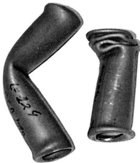
Figura 4.2 – Colapso quase-estático de tubos medindo 124 mm (à esquerda) e 123 mm (à direita)
