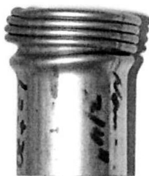
Figura 1.1 – Flambagem progressiva axissimétrica
