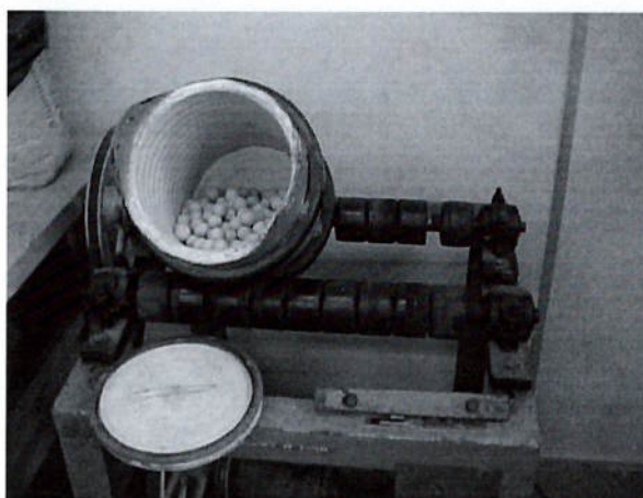
Figura 2.2 –Moinho de bolas para a mistura do pó (Freitas, 2001).
