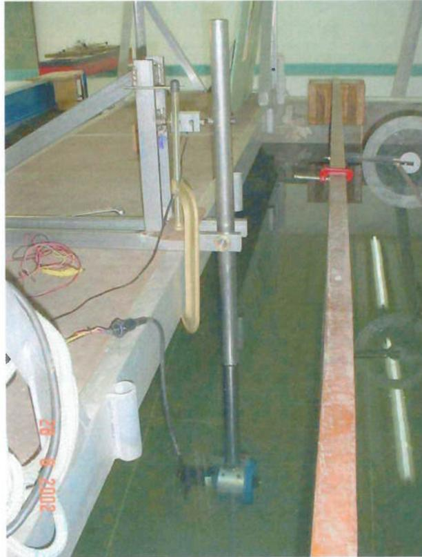
**Figura 3.2.** Estrutura de teste dos propulsores.
