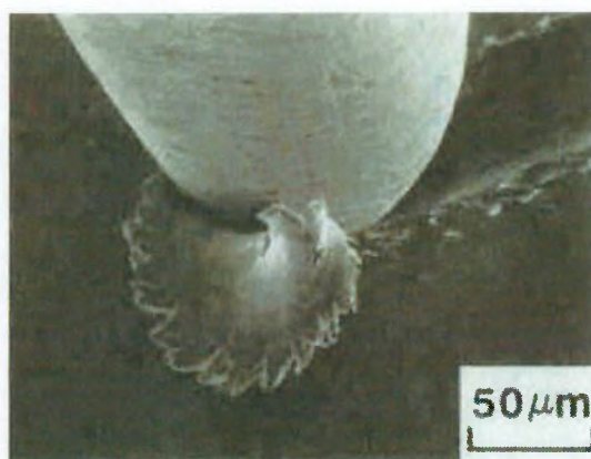
Figura 2.4 Mecanismo de microcorte (Tylczak; Oregon, 1992)
