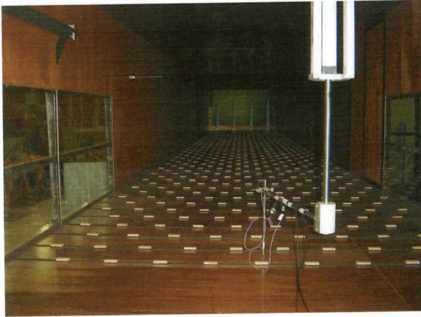
Figura (6.1): Posicionamento da sonda. Elemento de rugosidade de 15 mm disposto em padrão “diamante”.
