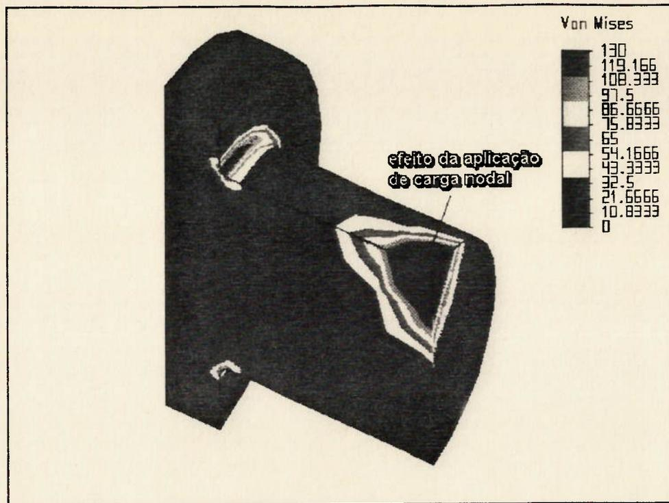
Fig. 5.14 - Distribuição das tensões:  $D/d = 1,67$ ;  $r/d = 0,05$  e  $s/D = 0,15$  - plano YZ
