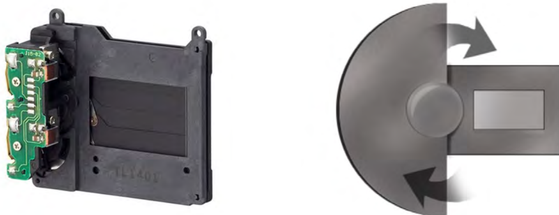
Fig. 61 – Obturador mecânico e Obturador de 180°
