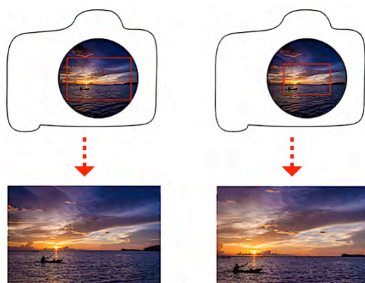
Fig. 09 – Limite dado pelo suporte (Fonte: http://www.dicasdefotografia.com.br/o-que-e-fator-de-corte/ )
