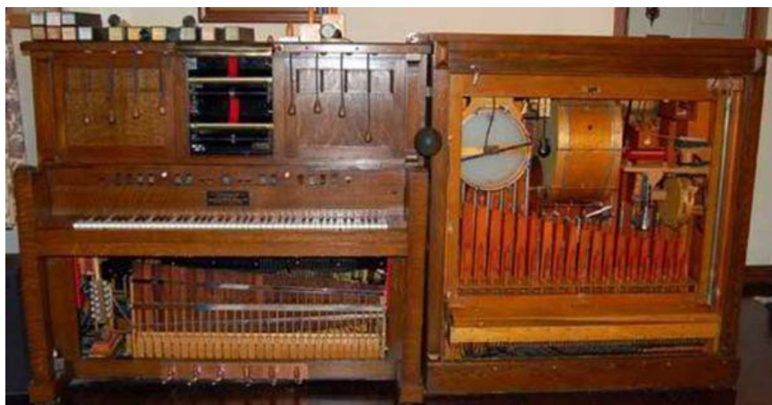
FIGURA 8 – Instrumento híbrido para efeitos sonoros no cinema mudo
