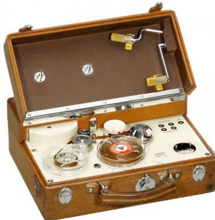
Figura 01 – Magnetofone MMK3 da AEG para rádio, cinema e TV, 1955
