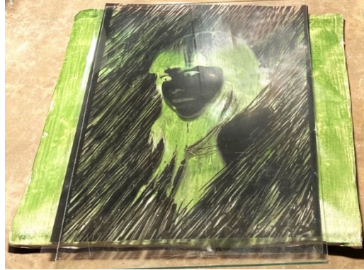
Figura 28 – Exposição à luz de conjunti cerâmica-diapositivo-vidro
