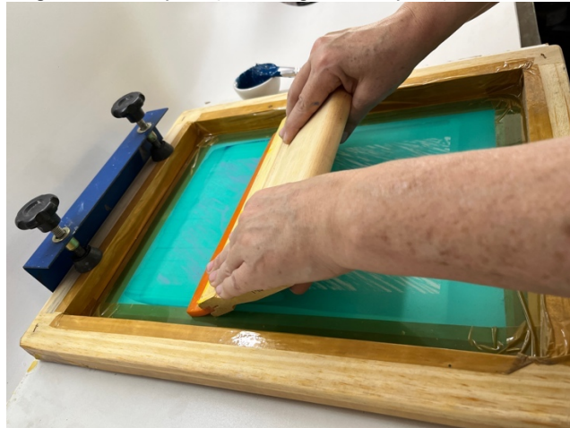
Figura 23 – Aplicação serigráfica – posição do rodo
