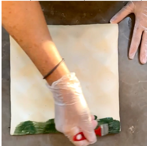
Figura 27 – Preparo de superfície cerâmica para transferência por emulsão diazoica
