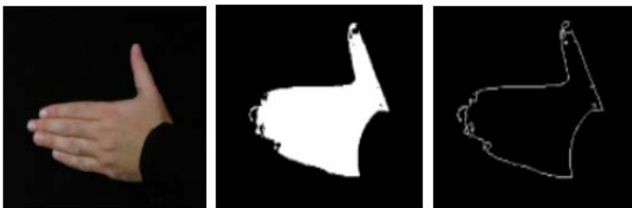
Figura 42. Registros de input , imagem segmentada e detecção de bordas de um método para reconhecimento de gestos a partir de aparência. Imagem adaptada de KHAN, R., IBRAHEEM, N. Survey on Gesture Recognition for Hand Image Postures . Computer and Information Science. Vol.5, n.3, 2012. Doi: 10.5539/cis.v5n3p110
