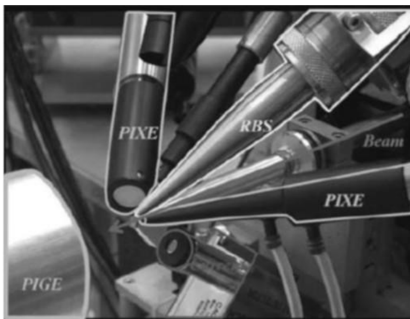
Figura 22 - Configuração dos equipamentos para uma medição simultânea de PIXE-PIGE-RBS no laboratório LABEC em Florença.
