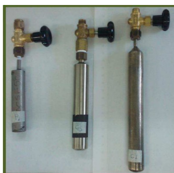
Figura 39 - Imagem ilustrativa das amostras da cromatografia gasosa recolhidas nos cilindros. Foto da Professora Celina L. Duarte.
