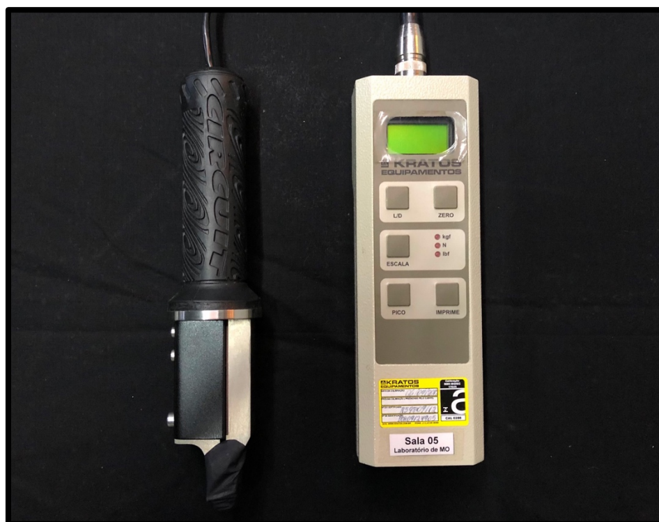
Figura 18. Dinamômetro para uso oral e ponta de garfo de mordida protegida com látex
