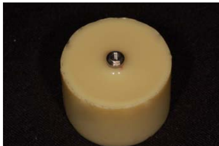
Figura 4.4 – Implante incluído na base de poliuretano com auxílio do delineador.
