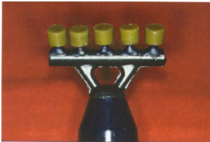
**Figura 7** – Posicionamento dos padrões de cera no pino formador de condutos de alimentação
