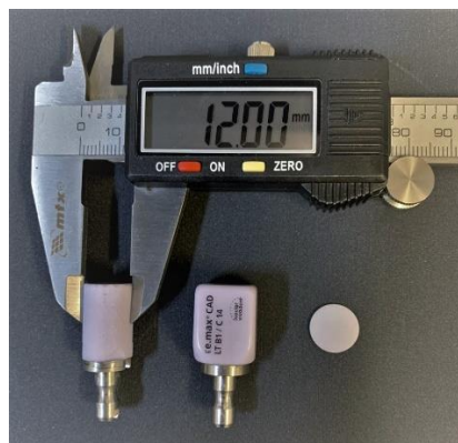
Figura 4.1 - Bloco cerâmico antes e depois da usinagem no torno e após o corte em discos
