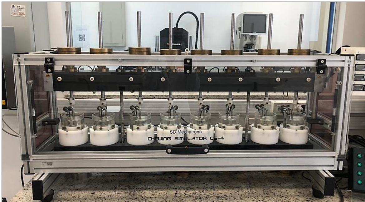
Figura 4.8 - Máquina simuladora da mastigação Mechatronik GmbH CS 4.8
