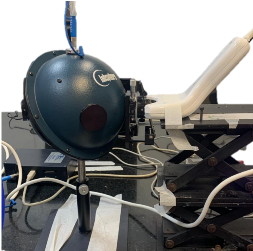
Figura 4.9 – Esfera integradora acoplada a um espectrômetro durante a leitura da transmitância.
