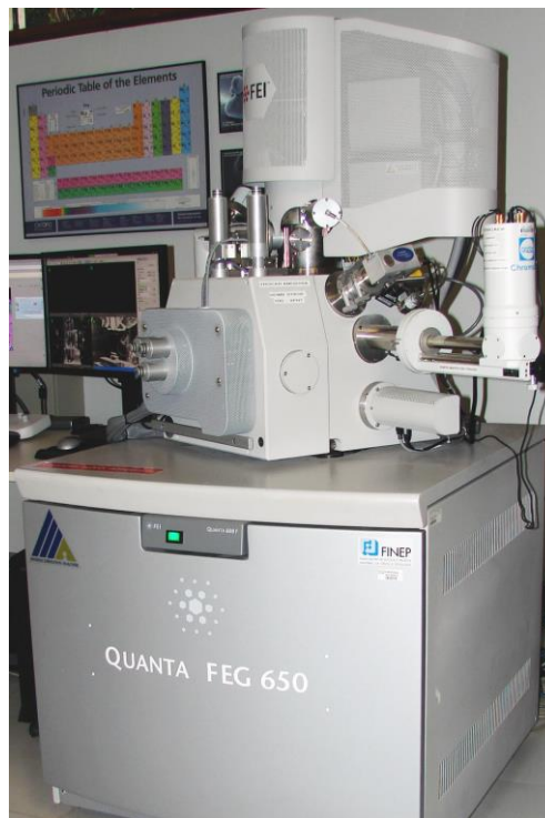
Figura 4.12 - Microscópio eletrônico de varredura Quanta FEG 650 do LCT – Poli USP
