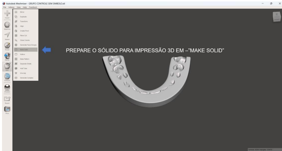
Figura 3 - Etapa de preparação da guia para impressão em “make solid”
