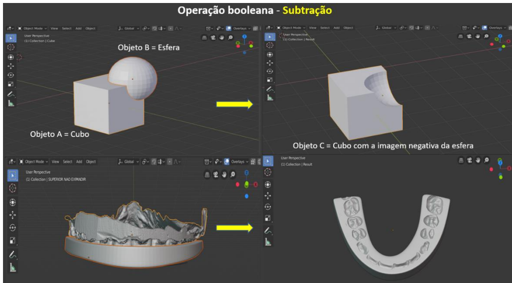
Figura 4.1 – Operação booleana aplicada no arquivo digital do modelo de gesso e guia cirúrgica
