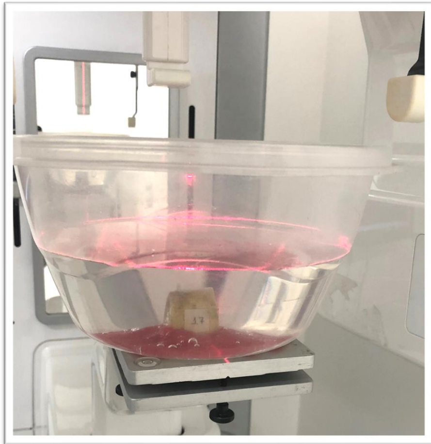
Figura 4.5 – Amostra preparada no interior de um recipiente de plástico preenchido com água e posicionado na plataforma de nivelamento com o auxílio das guias luminosas do equipamento de TCFC
