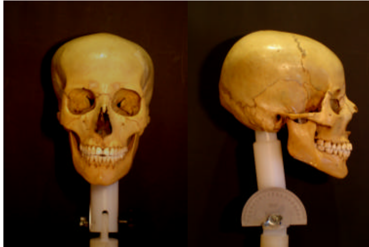
Figura 4.1 - Crânio seco sustentado pelo suporte que reproduziu os movimentos do pescoço humano no sentido vertical e horizontal
