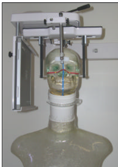
Figura 4.2 - Fantoma no cefalostato, mantido em posição com um busto de manequim e conexões na região do pescoço, em polipropileno
