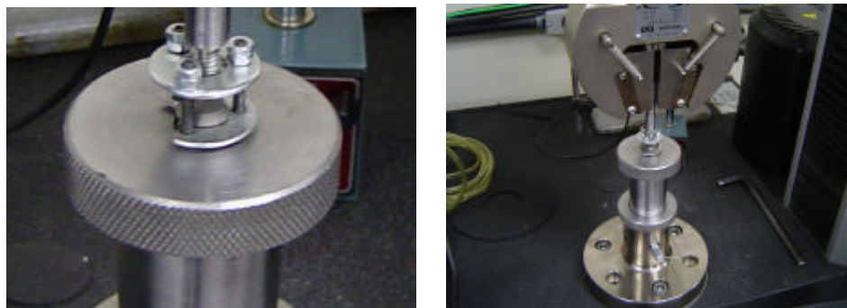
Figura 4.16 - Dispositivo de fixação preso à Instron
