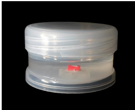
Figura 4.4 – Espécime imerso em 32 ml de solução desmineralizadora
