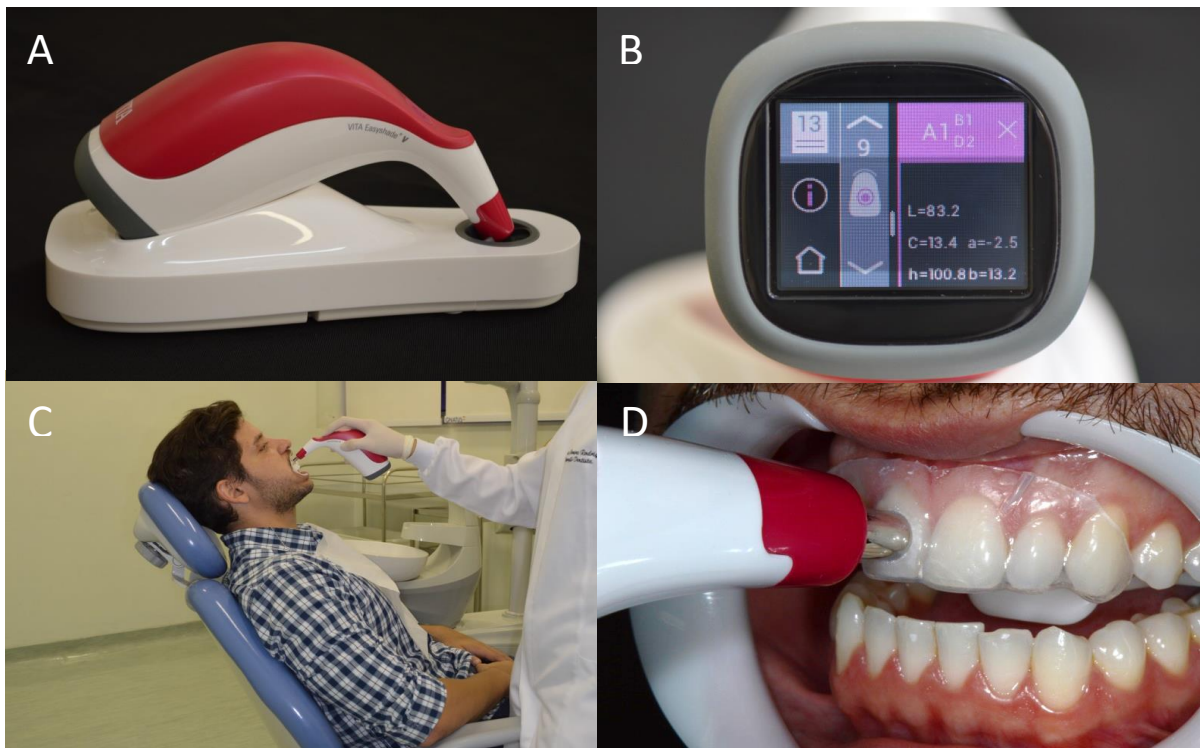
Figura 4.4 - (A) VITA Easyshade V; (B) Coordenadas CIE L* a* b; (C) Posição do Paciente; (D) Medição espectrofotométrica
