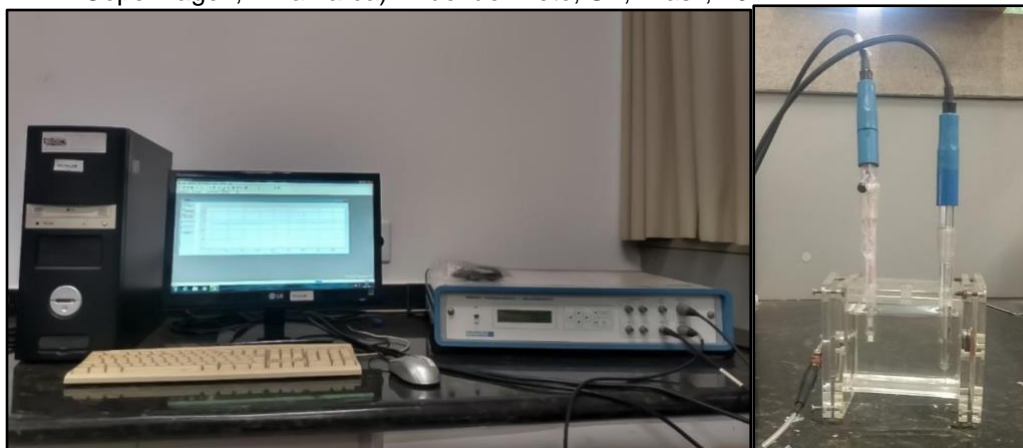
Figura 5 – Vista panorâmica do potenciostato / galvanostato modelo PGP201 (Radiometer Copenhagen, Dinamarca). Ribeirão Preto, SP, Brasil, 2021.
