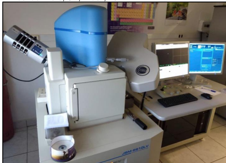
Figura 6 – Vista panorâmica do microscópio eletrônico de varredura e espectrômetro para microanálise elementar. Ribeirão Preto, SP, Brasil, 2021.
