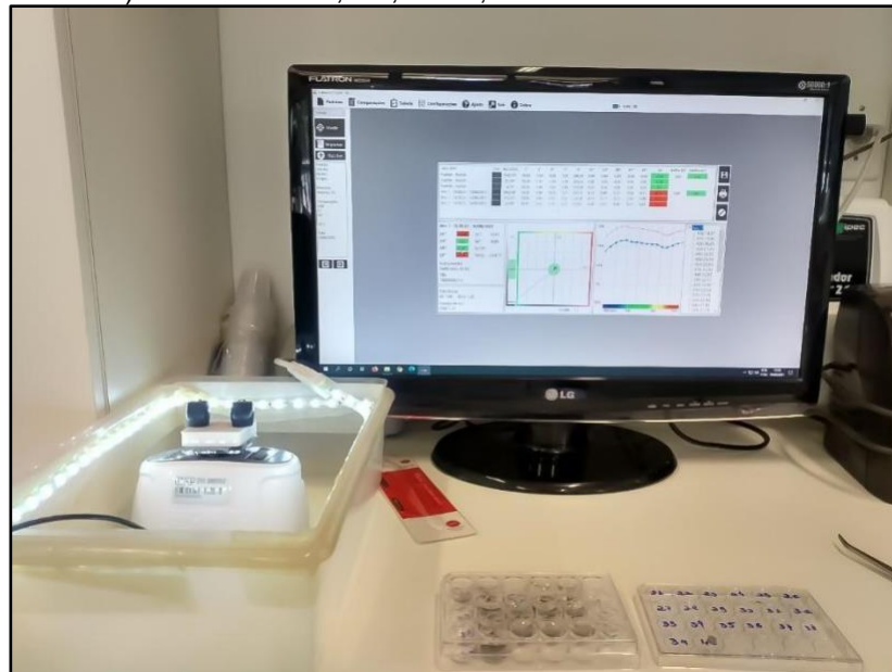
Figura 7 – Vista panorâmica do espectrocolorímetro portátil (Delta Color – delta vista 450G SN 7003000511). Ribeirão Preto, SP, Brasil, 2021.
