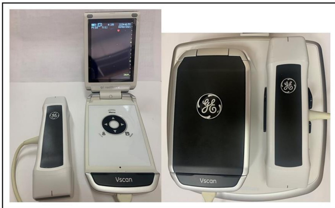
Figura 7 - Aparelho portátil de ultrassom com Transdutor Convexo Abdominal, de frequência de 3,5 a 5 Mhz. Ribeirão Preto, São Paulo, 2022
