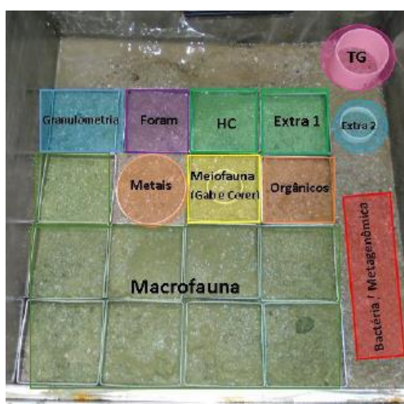
Figura 8. Subamostragem de sedimentos no box corer. A subamostra destinada à análise de foraminíferos está pintada de roxo. Fonte: Petrobrás, 2019.
