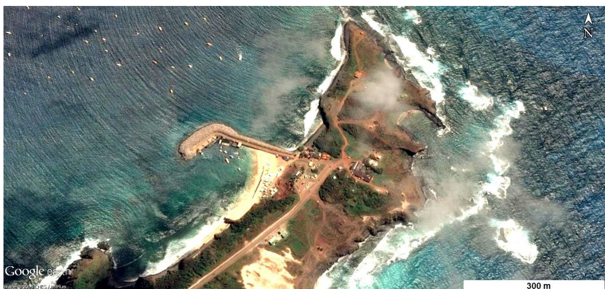
Figura 1.3 Porto de Santo Antônio, na Ilha de Fernando de Noronha, evidenciando o processo de assoreamento na área da bacia de evolução portuária (Fonte: Google Earth Pro).
