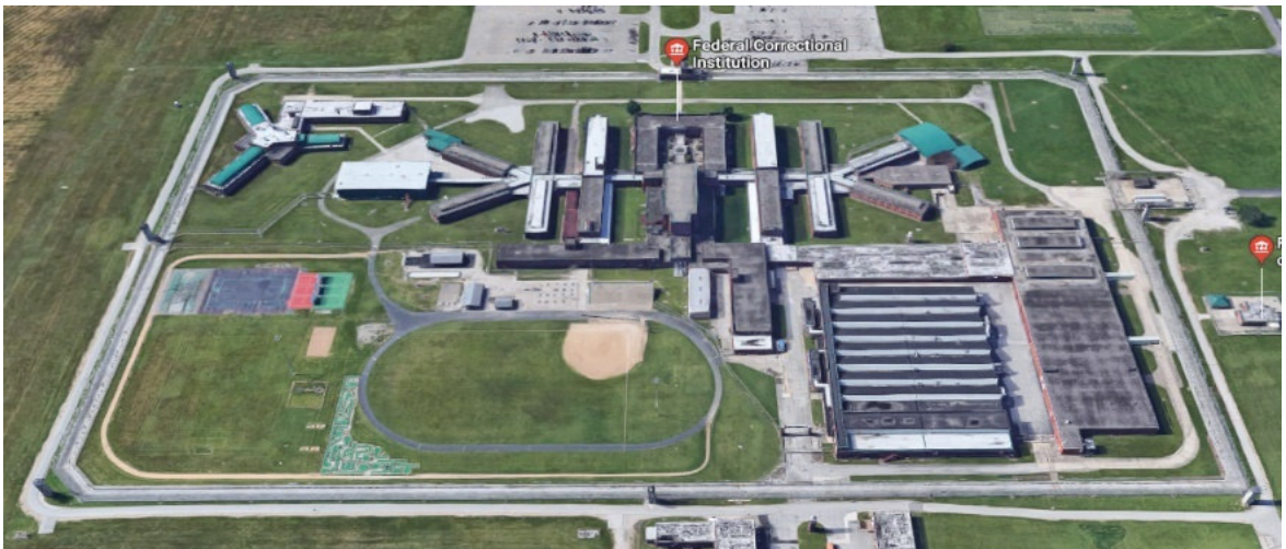
Figura 70: Vista aérea da Penitenciária Terre Haute, Indiana, Estados Unidos (1940): variação do modelo poste telegráfico com adição de blocos de celas radiais nas duas extremidades (Fonte: Google Earth, acesso em 24/08/2018, às 20:43h).
