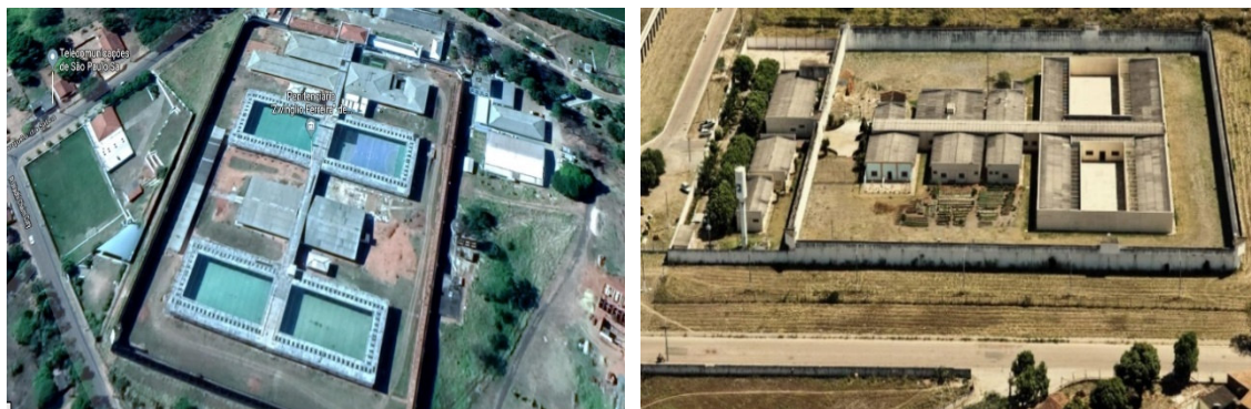
Figuras 114 e 115: Imagens aéreas da Penitenciária Zwinglio Ferreira (1961) em Presidente Venceslau/SP (esq.) e da Penitenciária Feminina Ana Maria do Couto May (2000) em Cuiabá/MT (dir.): variações do modelo poste telegráfico – pavilhões térreos com pátios e galpões para oficinas de trabalho e outros serviços acoplados ao eixo central de circulação (Fontes: Imagem da esquerda-Google Earth; Imagem da direita- Governo do Mato Grosso, disponível em www.mt.gov.br/ , acesso em 19/04/2019, às 00:30h).
