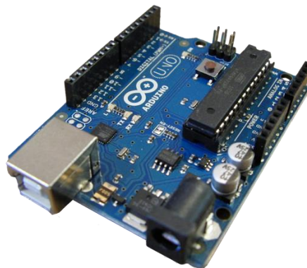
Figura 4 Placa de um microcomputador tipo Arduino.
