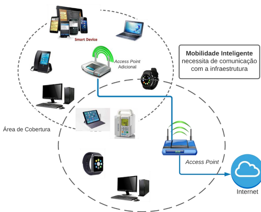
Figura 5 Estrutura de Tráfego e Coleta de Dados na perspectiva da IoT
