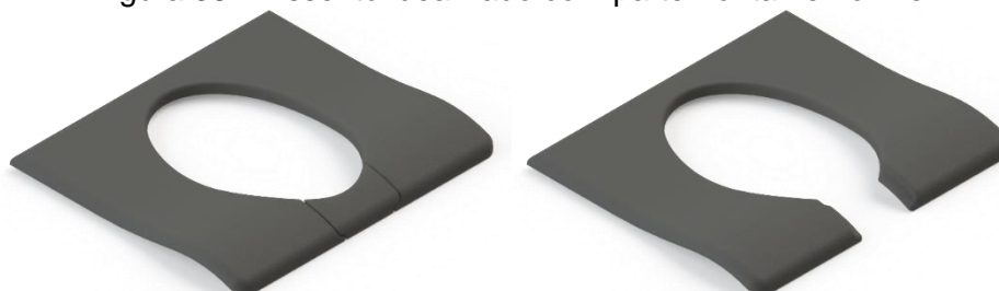
Figura 38 – Assento idealizado com parte frontal removível
