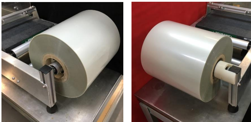
Figura 58 – Conjunto desbobinador apoiado na estrutura
