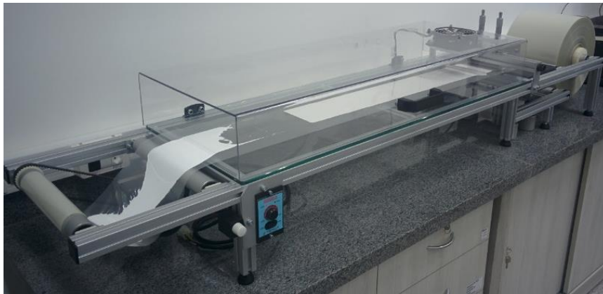
Figura 42 – Primeiro teste do equipamento de tape casting , SIMMaC
