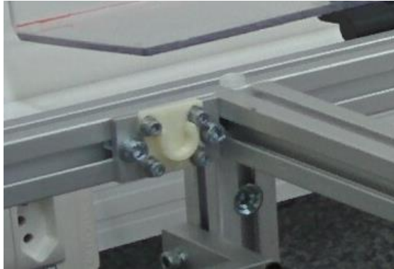
Figura 39 – Montagem dos suportes de eixo
